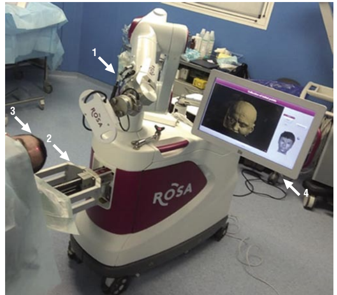
Рис. 2. Роботизированная стереотаксическая система «Rosa» (MEDTECH S.A.): 1 – роботизированная рука-манипулятор роботизированной станции; 2 – держатель для жёсткого фиксатора головы; 3 – голова пациента с наведённой на неё лазерной указкой в процессе бесконтактного распознавания и регистрации лица; 4 – сенсорный дисплей роботической станции.
