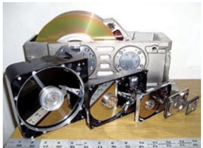
Рис. 1. Типоразмеры жестких дисков. Рядом дюймовая линейка (автор снимка Paul R. Potts)
