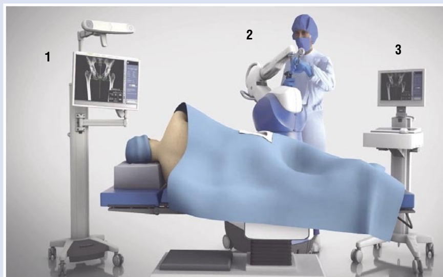
Рис. 1. Устройство роботической системы: 1 — стойка камеры компьютерной навигации с экраном хирурга, 2 — роботический манипулятор с силовой установкой, 3 — стойка ассистента-оператора.
