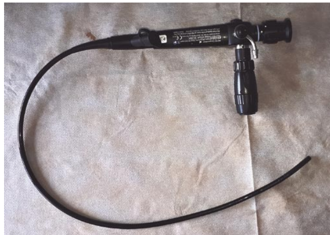
Рис. 1. Гибкий эндоскоп с автономным источником освещения.
