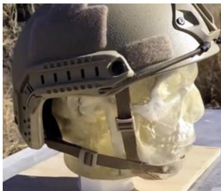
Рис. 3. Костно-мягкотканная антропоморфная модель головы, экипированная бронешлемом.
