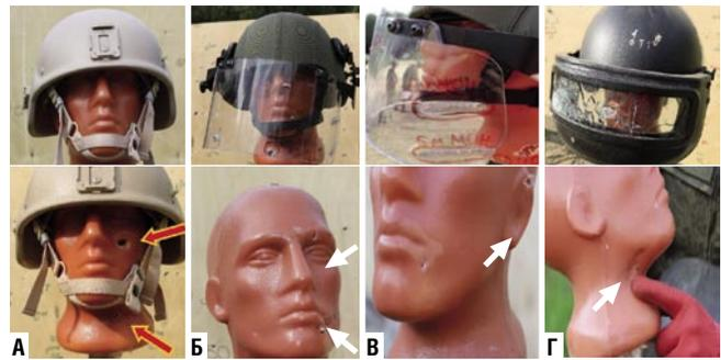
Рис. 9. А — пробитие осколками ЧЛО и шеи в зоне, не имеющей защиты (стрелки); Б–Г — единичные повреждения ЧЛО манекена (стрелки) в бронешлемах, имеющих защиту лица.
