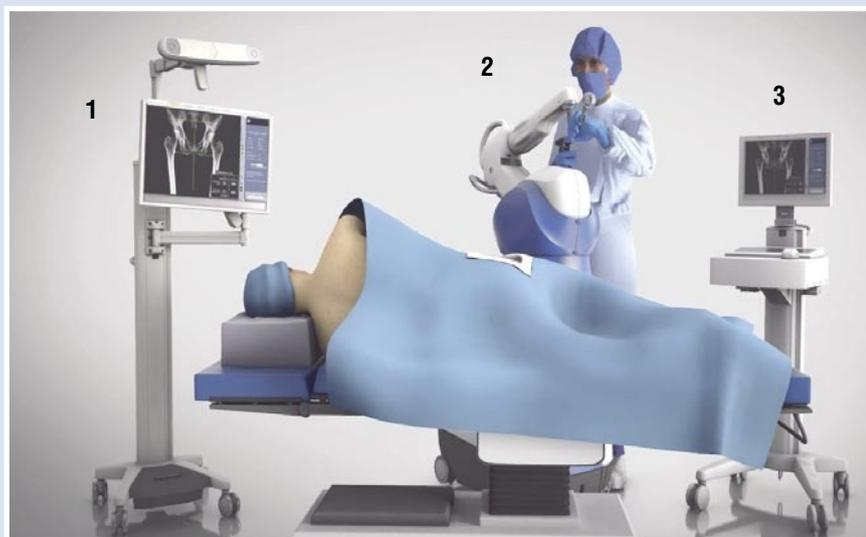
**Рис. 1.** Устройство роботической системы: 1 — стойка камеры компьютерной навигации с экраном хирурга, 2 — роботический манипулятор с силовой установкой, 3 — стойка ассистента-оператора.
