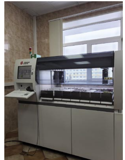
Рис. 9. Система пре- и постаналитической обработки образцов Automate 2500 (сортер).
