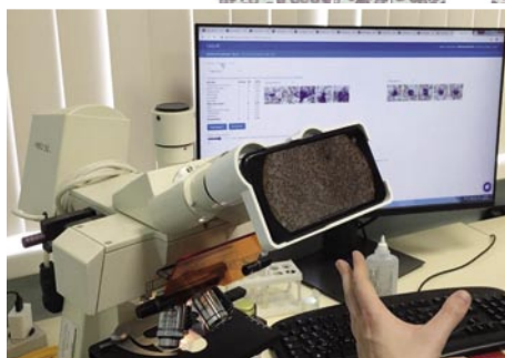
Рис. 12. Сортировка клеток по морфологическому признаку на устройстве Cell.AI, врач КДЛ валидирует результаты анализа на веб-портале.
