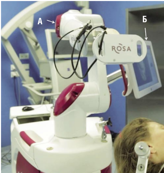
Рис. 5. Интраоперационное фото. Процесс регистрации пациента в навигационной роботизированной системе (А — манипулятор роботизированной системы; Б — рабочий монитор хирурга).
