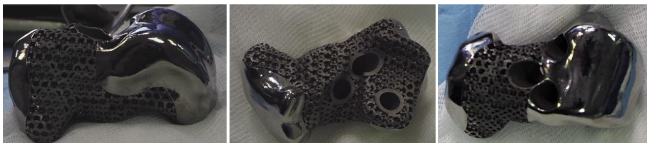
Рис. 4. Внешний вид имплантата (эндопротез таранной кости), изготовленного на 3D-принтере.
