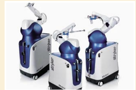
Рис. 5. Роботизированная система Мако для операций по замене суставов от компании Stryker.
