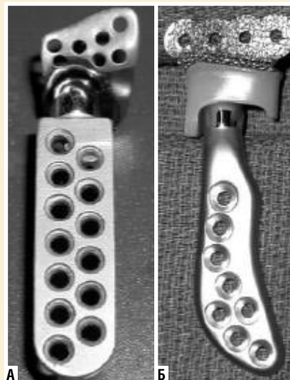
Рис. 3. А – конструкция шарнира Christensen изготовлена из литого кобальт-хромомолибденового сплава, обеспечивающего соединение металла с металлом. Существует одна форма мышцелка и на выбор предлагается 44 различных формы компонента ямки. Эти компоненты ямки также используются для гемиартропластики. Б – тотальный височно-нижнечелюстной протез, изготовленный по индивидуальному заказу, состоит из ковального титанового вкладыша для ямки, покрытого титановой сеткой для роста кости в ямке и крепления к суставной поверхности из сверхвысокомолекулярного полиэтилена. Специально подобранный элемент нижней челюсти состоит из стержня и мышцелковой головки из ковального кобальт-хромомолибденового сплава.
