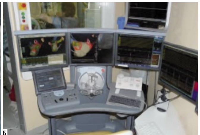
Рис. 16. Система Sensei. А – рука робота, в которой зафиксирован абляционный катетер, проведенный в сердце пациента через правую бедренную вену. Б – рабочая станция для удаленного управления катетером при помощи джойстика (в центре рисунка). Из Petra J. et al. Cor et Vasa Volume 2012; 6: 408-413.
