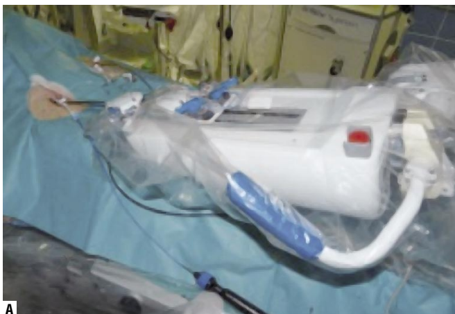
Рис. 16. Система Sensei. А – рука робота, в которой зафиксирован абляционный катетер, проведенный в сердце пациента через правую бедренную вену. Б – рабочая станция для удаленного управления катетером при помощи джойстика (в центре рисунка). Из Petra J. et al. Cor et Vasa Volume 2012; 6: 408-413.
