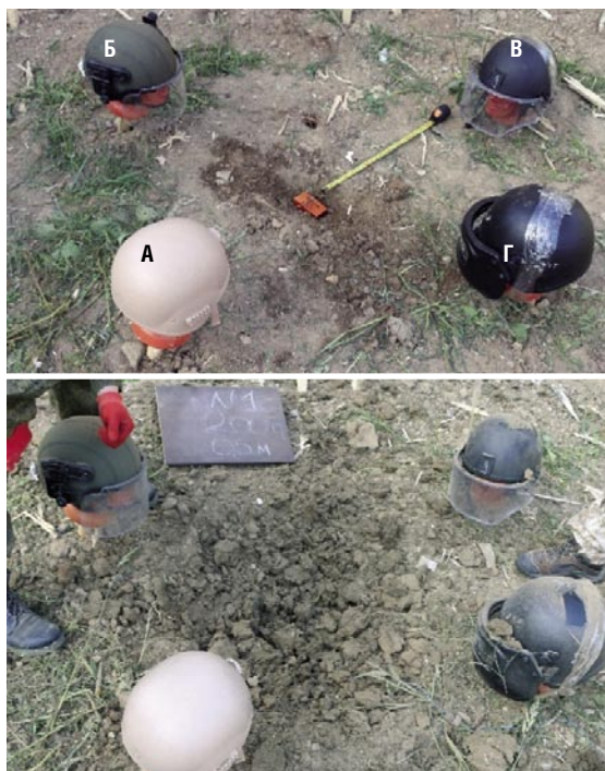
Рис. 5. Схема расположения объектов исследования в испытываемых бронешлемах, размещенных на грунте, а) без защитного забрала; б) с защитным забралом; в) с двойным защитным забралом; г) — усиленная защита лица.
