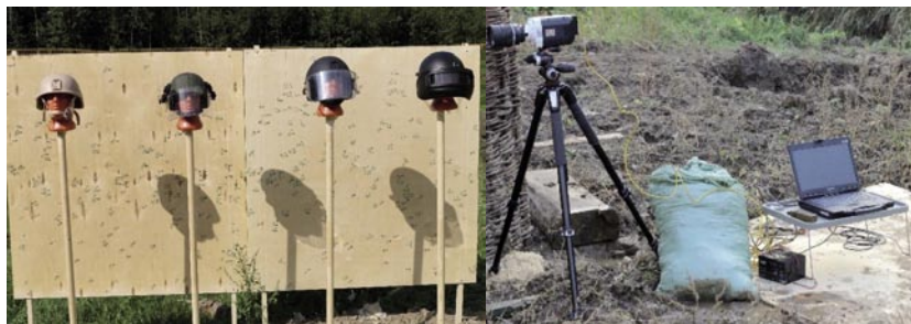
Рис. 4. Головные части манекенов в бронешлемах перед проведением испытаний и оборудование для высокоскоростной видеофиксации результата.
