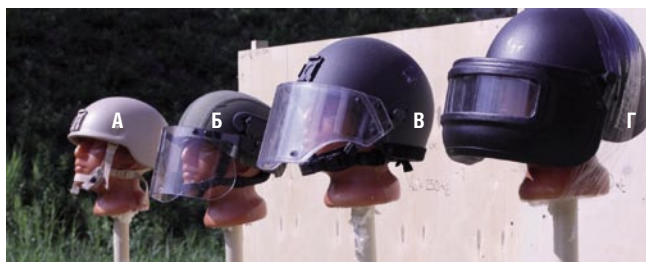
Рис. 1. Схема расположения голов манекенов в испытываемых бронешлемах, размещенных на высоте 1,8 м от грунта, а) без защитного забрала; б) с защитным забралом; в) с двойным защитным забралом; г) усиленная защита лица.
