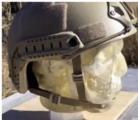
Рис. 3. Костно-мягкотканная антропоморфная модель головы, экипированная бронешлемом.
