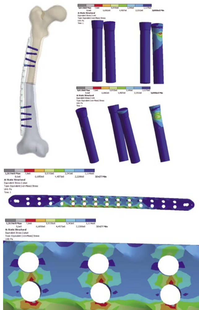
Рис. 6. Поля напряжений и деформаций в винтах и пластине при ходьбе.
